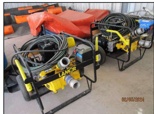
ภาพถ่ายที่ 2.2-7 อุปกรณ์กำจัดครบน้ำมัน
