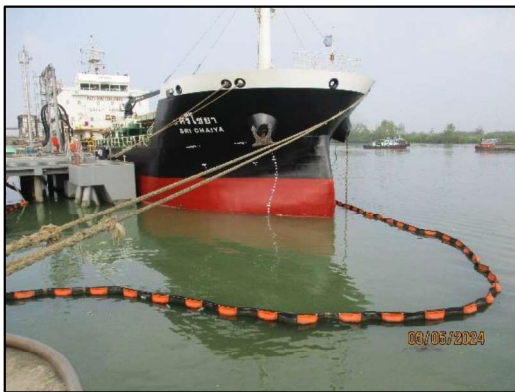
ภาพถ่ายที่ 2.2-10 การควบคุมการรั่วไหลของน้ำมันระหว่างการขนถ่าย
