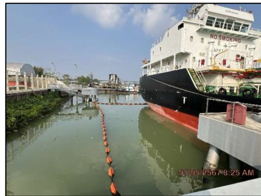
ภาพถ่ายที่ 2.2-10 การควบคุมการรั่วไหลของน้ำมันระหว่างการขนถ่าย
